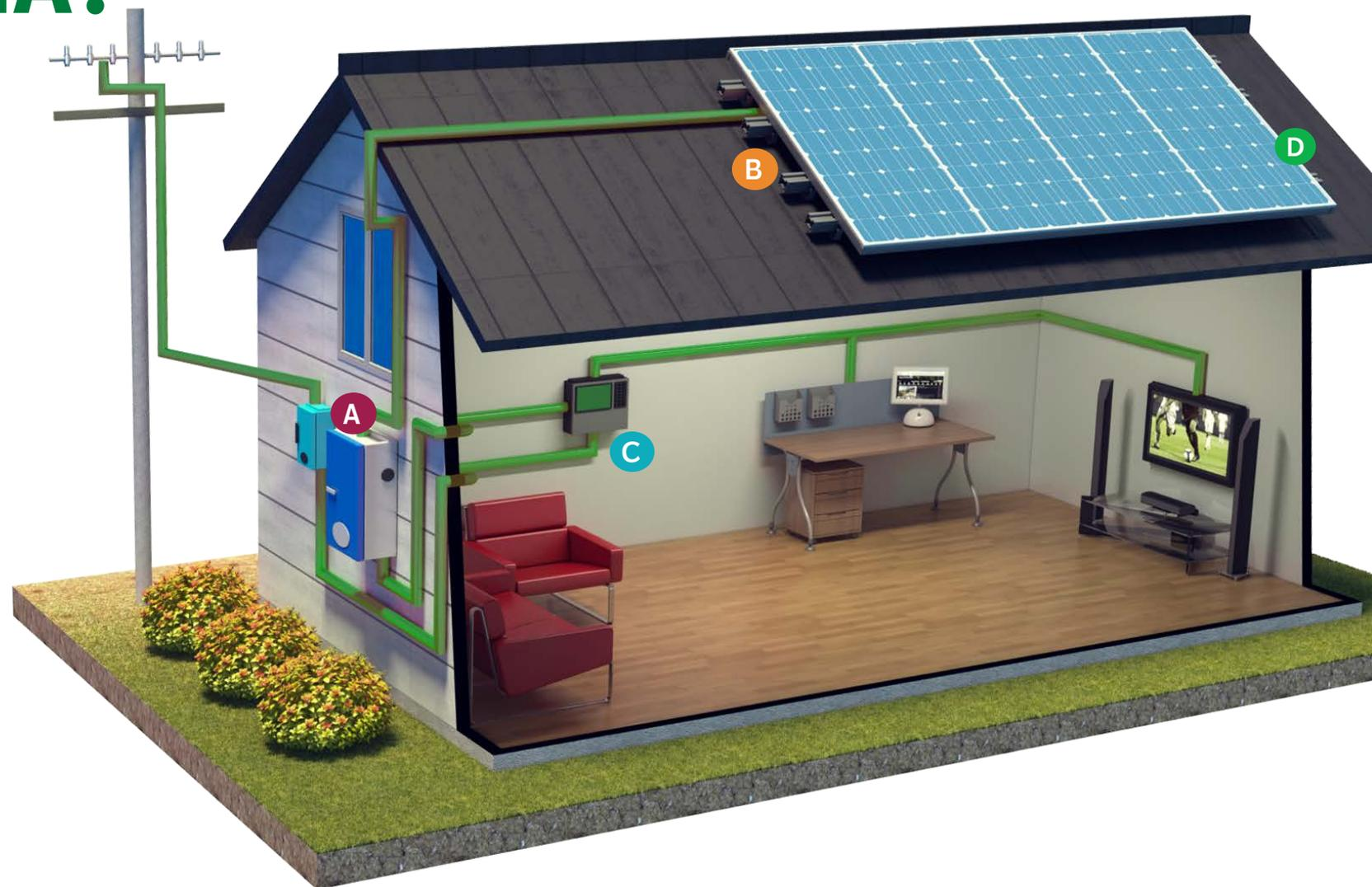
O equipamento converte a energia solar e encaminha para o quadro de luz, que libera a energia para ser usada em toda a estrutura. **Simples, não é mesmo?**
